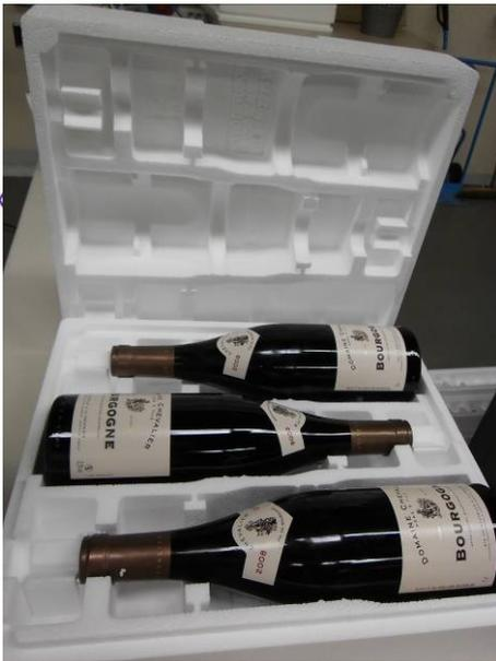
Figure 8 Exemple Coffret 3 Bouteilles après chute
