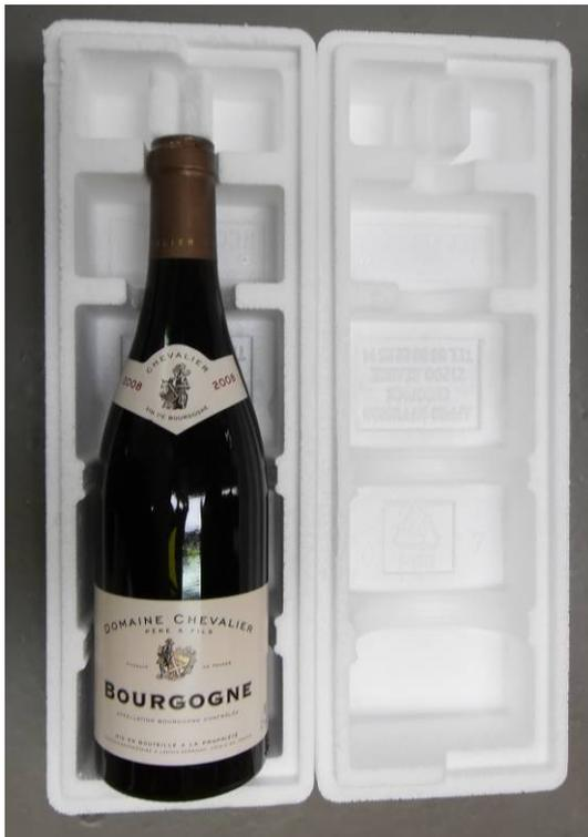
Figure 6 Exemple Coffret 1 Bouteille après chute
