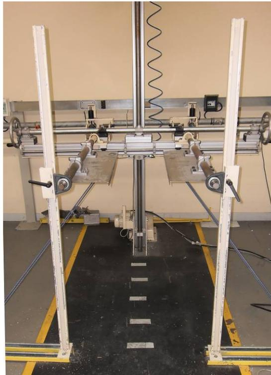
Figure 1 Banc de chute
