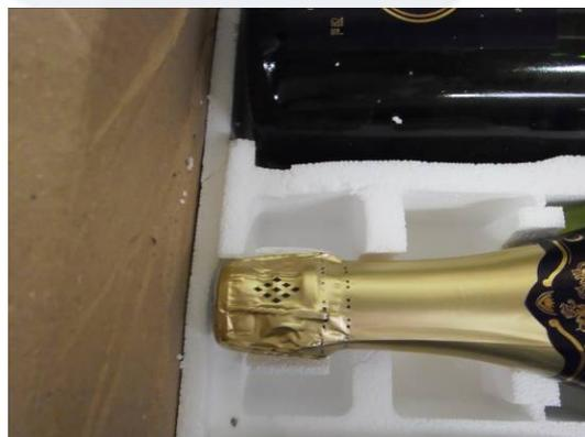
Figure 12 Exemple Coffret 12 Bouteilles après chute
