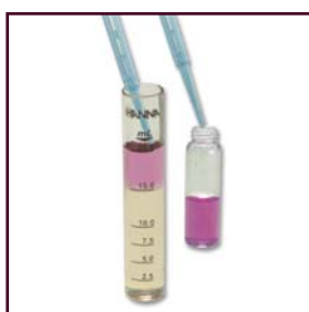
2 Remplir la cuvette de mesure avec l'échantillon préparé
