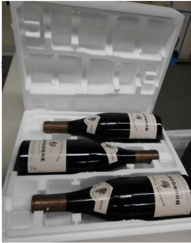
Figura 8 Esempio di cofanetto 3 bottiglia dopo caduta
