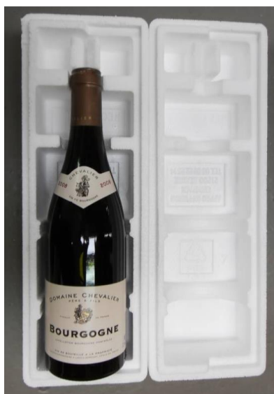
Figura 6 Esempio di cofanetto 1 bottiglia dopo caduta
