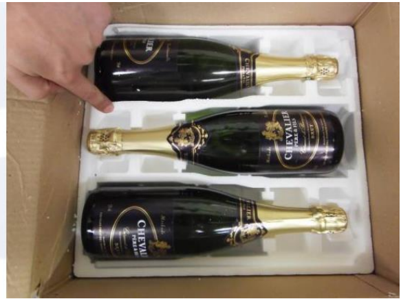
Figura 11 Esempio di cofanetto 12 bottigli dopo caduta
