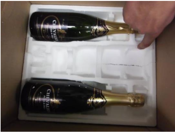
Figura 10 Esempio di cofanetto 12 bottiglia dopo caduta
