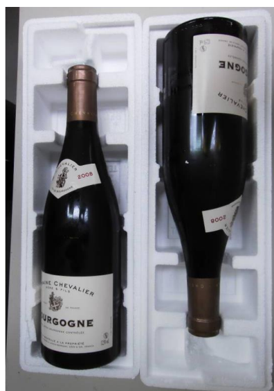
Figura 7 Esempio di cofanetto 2 bottiglie dopo caduta
