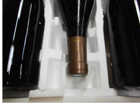
Figura 9 Esempio di cofanetto 3 bottigli dopo caduta
