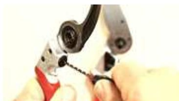
**Sostituire il battente**
