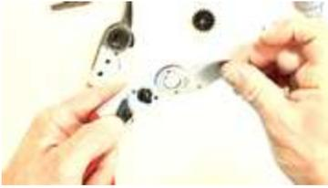
**Sostituire la lama**
