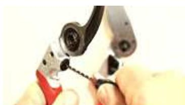
**Sostituire il battente**
