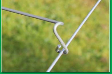
3- Régler la hauteur idéale, en poussant sur les bras, et en faisant glisser l'écarteur dans le piquet.
